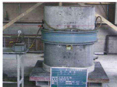
接合部の水密性試験状況
