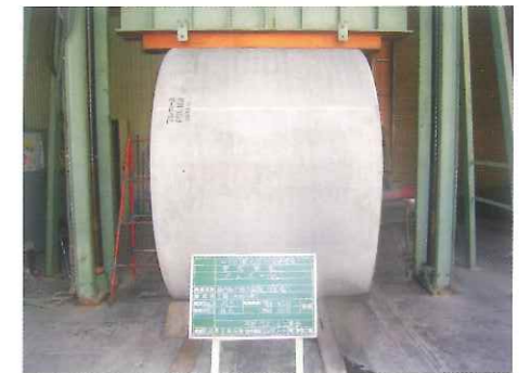
側方曲げ試験状況
