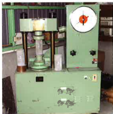
コンクリート圧縮強度試験状況
