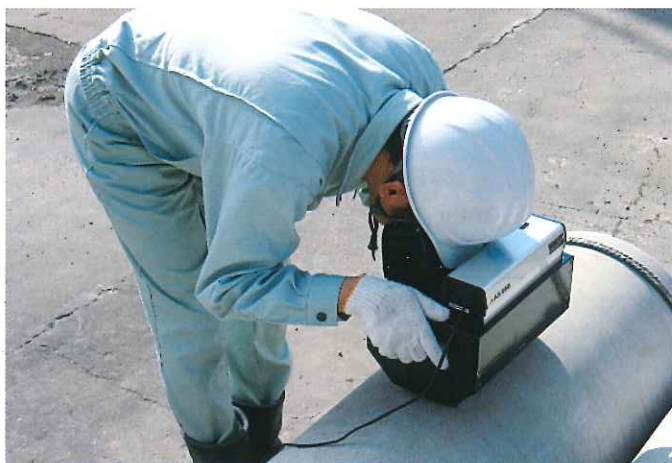
●目視タイプの検出器によるビック剤混入の確認状況
