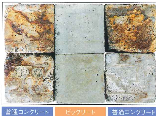
●曝気槽にて2年間暴露試験を行ったテストピースの腐食状況比較
